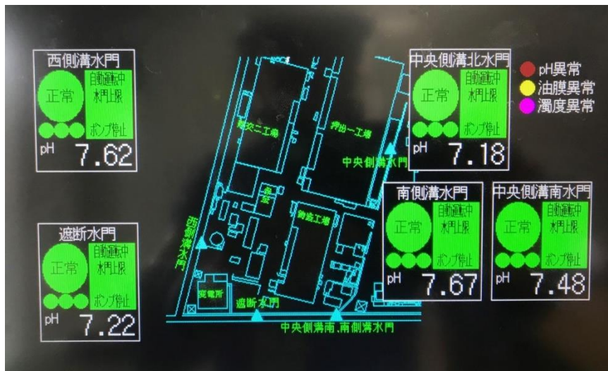
写真2. 排水監視モニター
