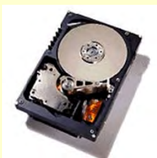
HDD（ハードディスクドライブ）用小型モーター
