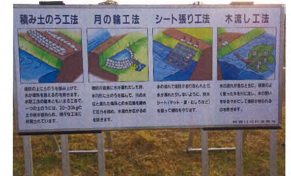
水防訓練で実施する各工法
