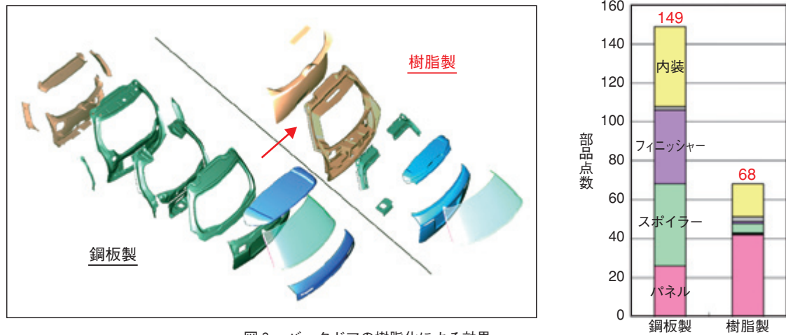
図3 バックドアの樹脂化による効果 Figure 3 Effectiveness of back door resinification
