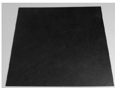
図6 回収CF不織布を用いたリサイクルCFRP
