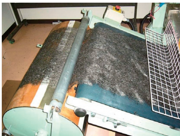
図4 カード機による回収CF不織布の作製
