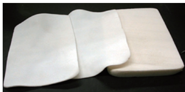
図8 シルクフィブロインからなるシート状の多孔質体の例 Figure 8 Example of sponge sheets made from silk fibroin
